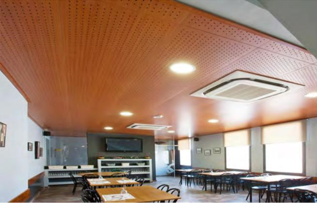
Per un **coefficiente di assorbimento ottimale in classe A** è necessario prevedere uno spazio di almeno 30/40 mm tra la parete ed il retro dei pannelli per inserire un materassino di fibra minerale o di poliestere con una densità di 30-40 kg/m<sup>3</sup>.
